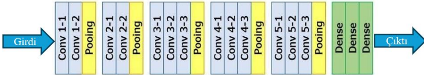
Şekil 2. VGG16 mimari yapısı
