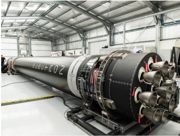
Şekil 9. Fırlatma Hazırlık Alanı (Motor Entegrasyonu)
