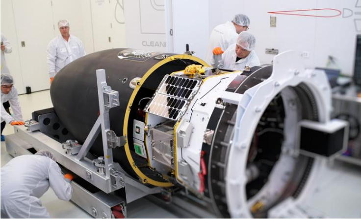
Şekil 15. Fırlatma Hazırlık Alanı (Kaplamanın (Fairing) Entegrasyonu)
