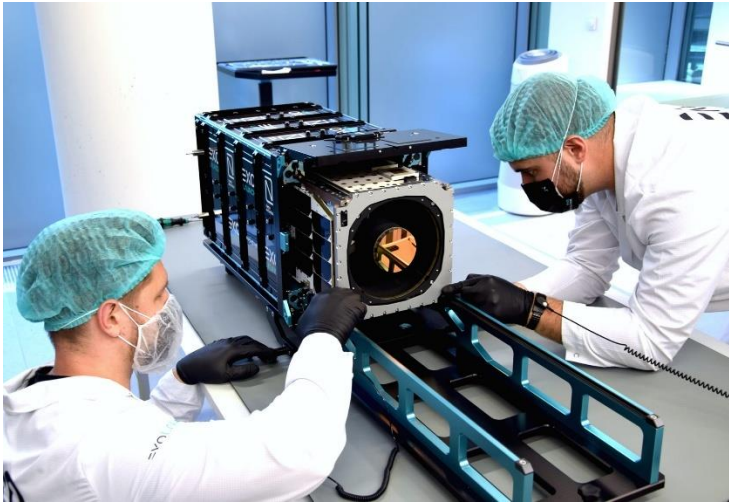
Şekil 13. EXOPod Entegrasyon İřlemleri
