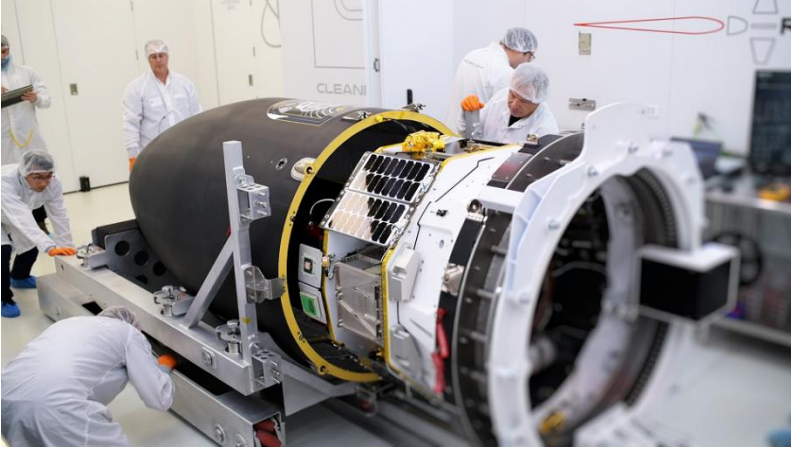
Şekil 29. Electron Roketinin Faydalı Yük Kısımı Kaynak: (RocketLab, 2024).
