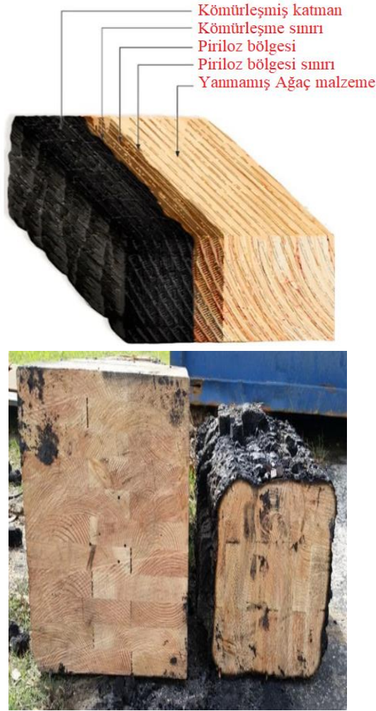
Şekil 11. Ağaç malzemedeki kömürleşmiş katman, piriloz bölgesi (Le ve Tsai, 2019) ve yangın sonrası bir TAM malzemenin görünümü (URL-2)
