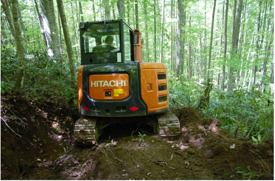
Şekil 2. Sürütme yolu yapımında kullanılan mini ekskavatör
