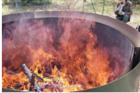
Resim 2. Taşınabilir ve yerinde biyokömür üretimi için kullanılan Ring of Fire fırını (Fotoğraf: wilsonbiochar.com; Amonette vd., 2021)
