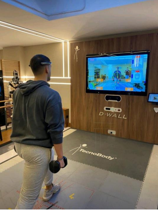
Şekil 1. TecnoBody D-Wall cihazı ve FocusCalm EEG tabanlı sistemin geri bildirim (feedback) mekanizmaları ile kombine kullanımı, dayanıklılık parametrelerinin çok boyutlu takibine yönelik bir örnek.
