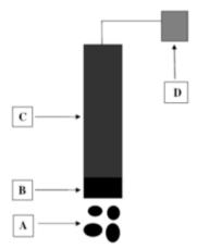
Figure 2. A) Analyt B) Bioactive layer C) Electrode D) Transducer[2]
