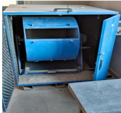
Şekil 4. Los Angeles deney aleti
