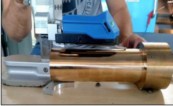
Şekil 9: Deney parçası üzerinde yüzey pürüzlülüğünün ölçülmesi
