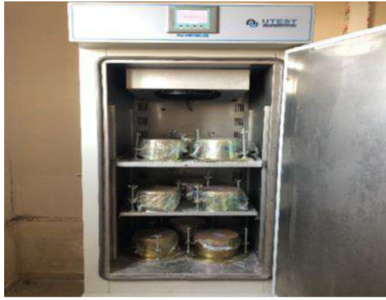
Şekil 2. Kapalı sistem donma-çözünme cihazı
