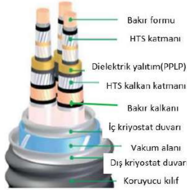
Şekil 2. HTS kablo yapısı (Das vd., 2015:311-322)
