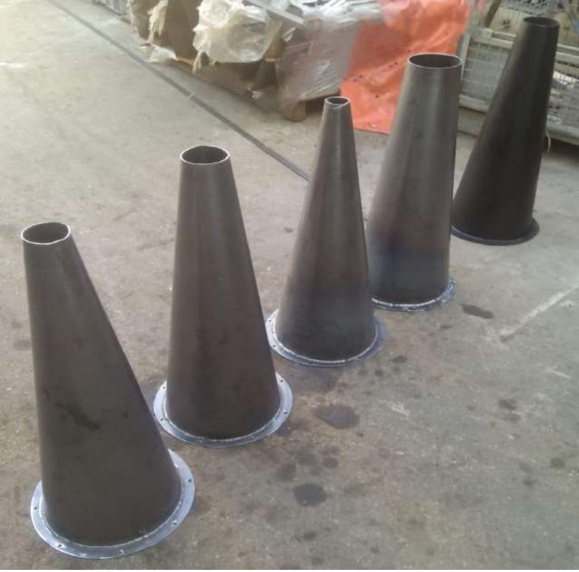
Şekil 5 Beş farklı koni ucu çapına sahip ayrılma odaları
