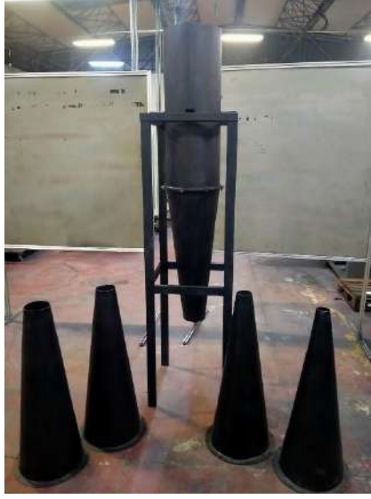
Şekil 7 Siklon ayırıcı montajı
