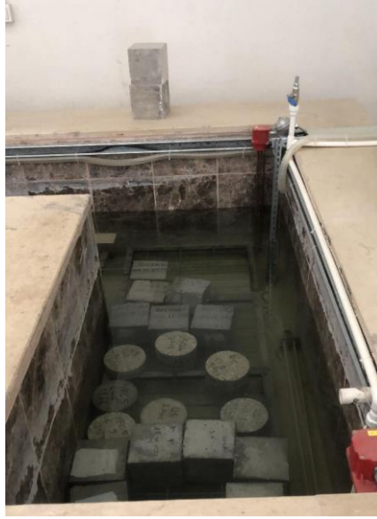
Şekil 14: Beton Numunelerinin Kür Edilmesi
