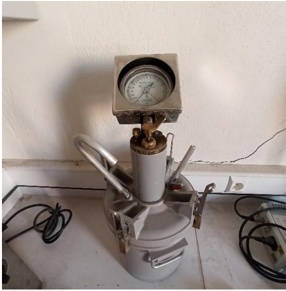
Şekil 8: Hava Muhtevası Tayini Deney Cihazı
