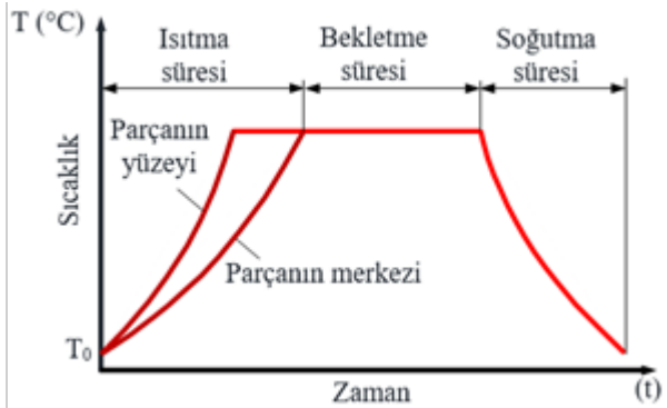
Şekil 5: Tavlama mekanizması (Savaşkan, T, 2009).
