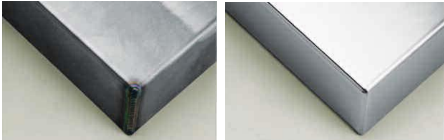
Şekil 9: Kaynak (a) ve asitleme işleminden (b) sonra kaynaklı bağlantı
