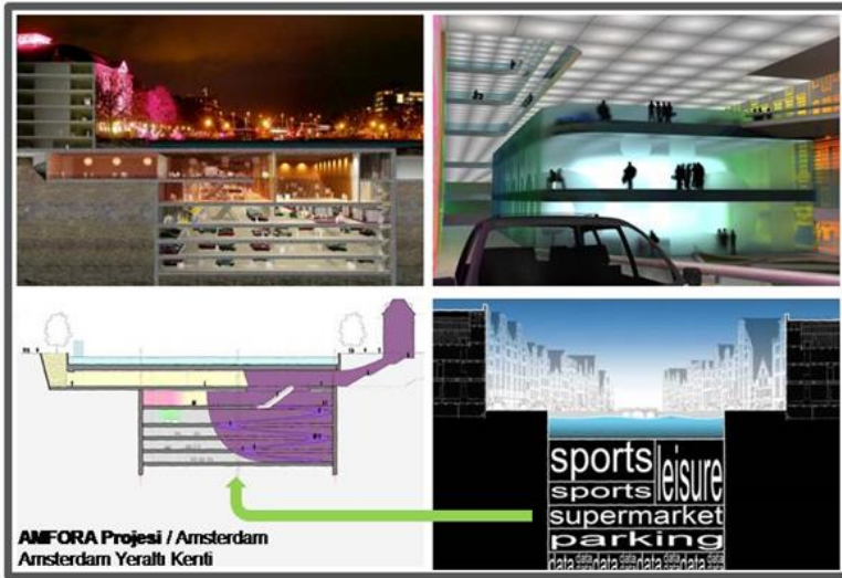
Şekil 4. Amfora Projesi - Amsterdam; Yeraltı Şehri. Kanalın altına yeni mekanların inşası (ZJA, 2023).
