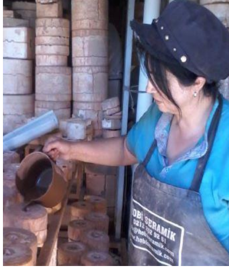
Görsel 12: Menemen kilinden elde edilen kırmızı döküm çamuru ile döküm uygulaması (Demir 2018).
