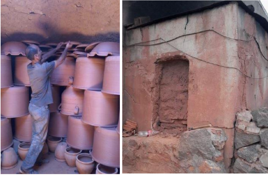
Görsel 13-14: İşlerin istiflenmesi (solda), kapısı kapatılarak sıvanmış odunlu fırın (Sağda) (Demir 2018).
