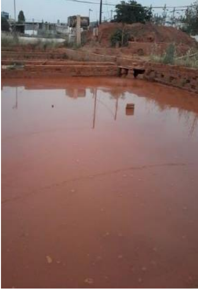
Görsel 4-5: Çamurun havuzda bekletilerek suyundan uzaklaştırılması ve kesilmesi (Demir 2018).
