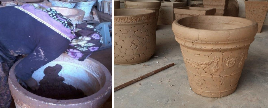
Görsel 10-11: Alçı kalıp içine sıvama uygulaması (Solda) (Demir 2018), Alçı kalıp içine sıvama yöntemi ile oluşturulmuş saksı (Sağda) (Küpçü Kardeşler 2014).
