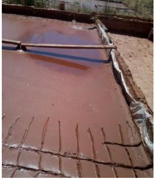
Görsel 4-5: Çamurun havuzda bekletilerek suyundan uzaklaştırılması ve kesilmesi (Demir 2018).
