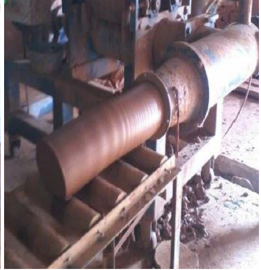
Görsel 6-7: Çamurun dinlendirilmesi ve vakum prestren geçirilmesi (Demir 2018).
