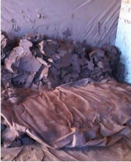
Görsel 6-7: Çamurun dinlendirilmesi ve vakum prestren geçirilmesi (Demir 2018).
