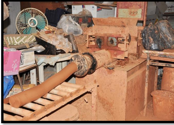
Görsel 23: Çamurun vakumpres ile havasının alınması (Çakır ve Ertürk 2016).
