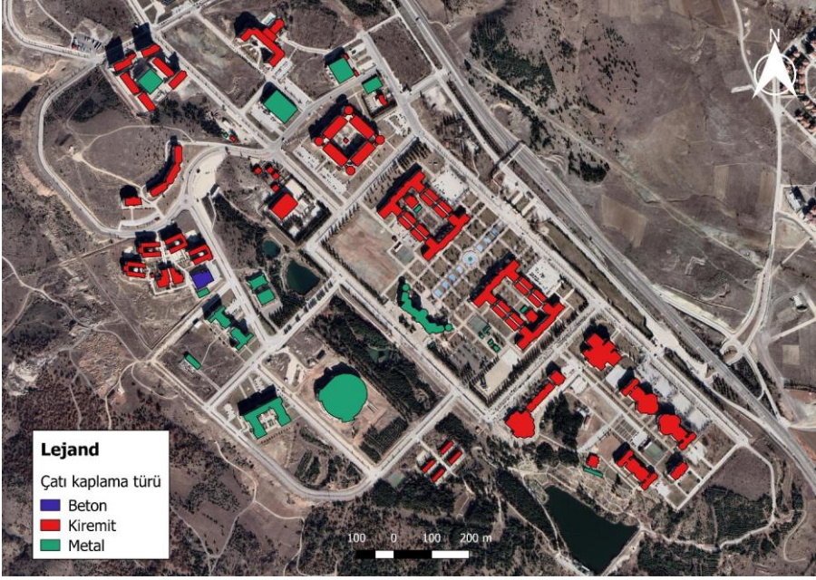
Şekil 3: Evliya Çelebi Yerleşkesindeki çatı türleri
