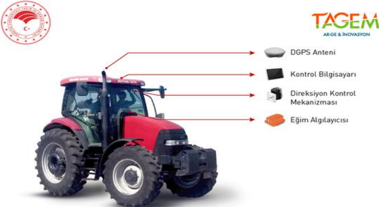
Şekil 5. Traktörlerde Otomatik Dümenleme Sistemi (OTAK) Projesi kapsamında geliştirilen prototip (Anonim, 2021c)
