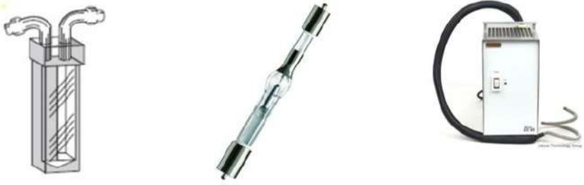
Şekil 5: Deneyin yapılışında kullanılan küvet, lamba termoregülatör ve lazer A) Yan Kollu (side arm) B) Cıva Lambası C) Soğutmalı Termoregülatör Küvet
