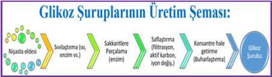
Şekil 1. Glikoz şurupları üretiminin şematik gösterimi (Şekil yazarlar tarafından oluşturulmuştur).
