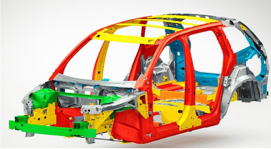
Şekil 9. Güvenlik Kafesi Yapısı (Volvo Cars, 2013)
