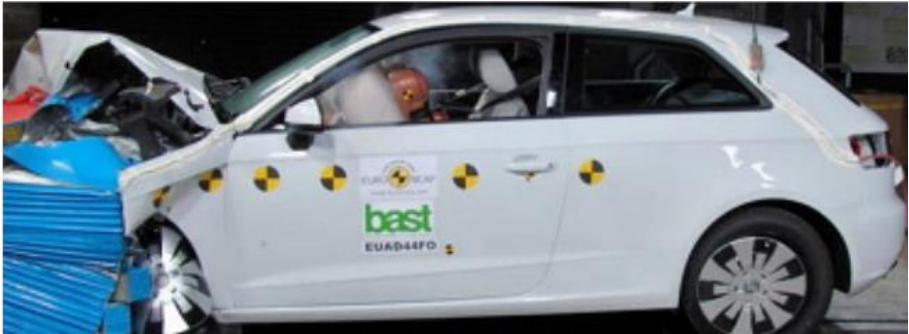
Şekil 8. Çarpışma Anında Araçta Oluşan Deformasyon(Vargas Victor Miguel 2022)
