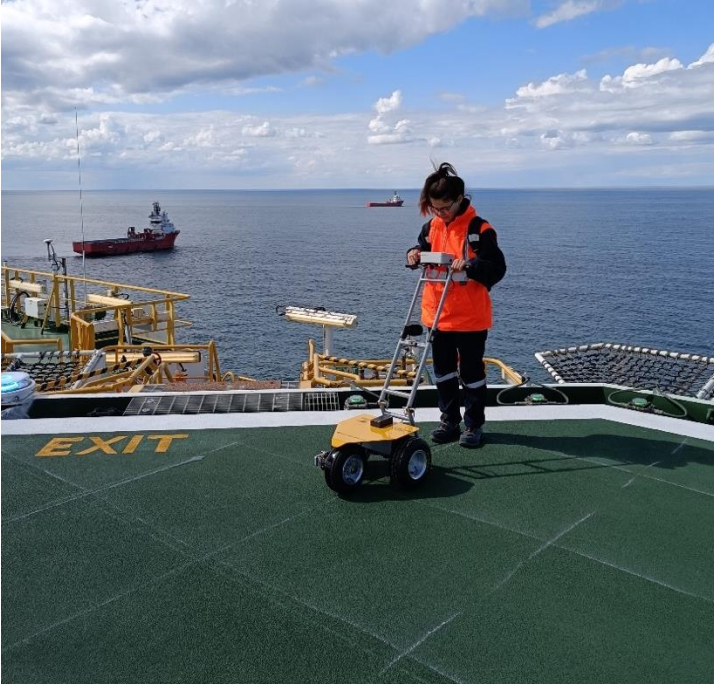
Şekil 6. Helideck Micro Grip Tester Helideck cihazının teste hazırlanması
