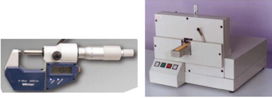
Şekil 3. Boyut ölçüm cihazları, mikrometre ve kesit ölçüm istasyonu
