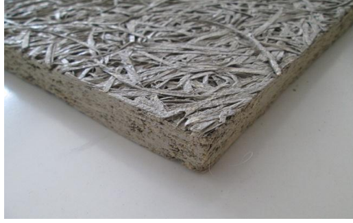
Şekil 7: Ahşap talaş levha (URL 8)
