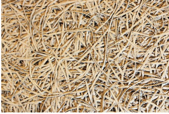
Şekil 8: Çimentolu odun kompozit levha örneği (URL 10)
