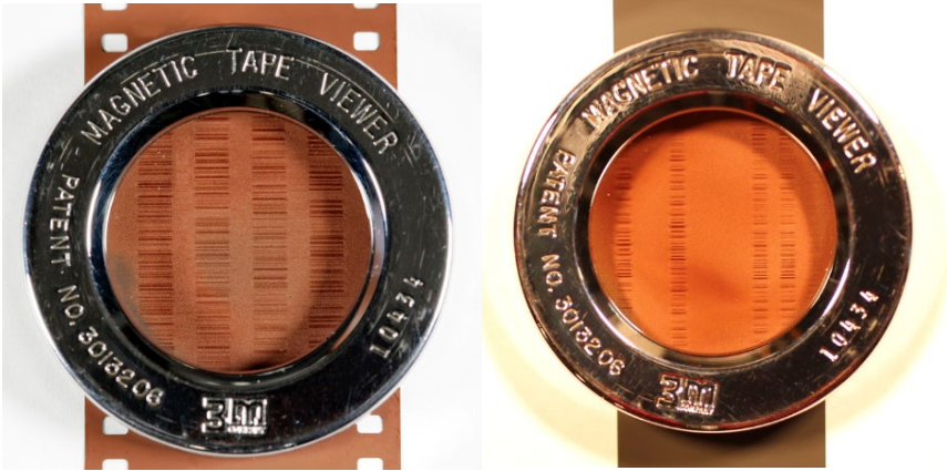
Şekil-1. (Sol) 4-Kanal Ses Taşıyan 35mm. Manyetik Film ve (Sağ) 8-Kanal Ses Taşıyan 1-inch Manyetik Bant
