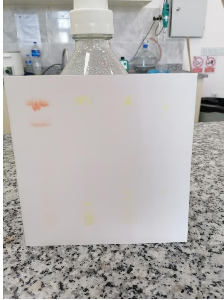
Şekil 4. TCL kağıt kromotografisinde pigmentlerin ölçülmesi
